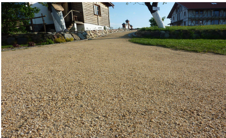
Nawierzchnia typu HanzaVia stabilizowana stabilizorem roślinnym
